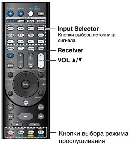
**1** Нажмите кнопку Receiver и затем одну из кнопок селектора входов.
