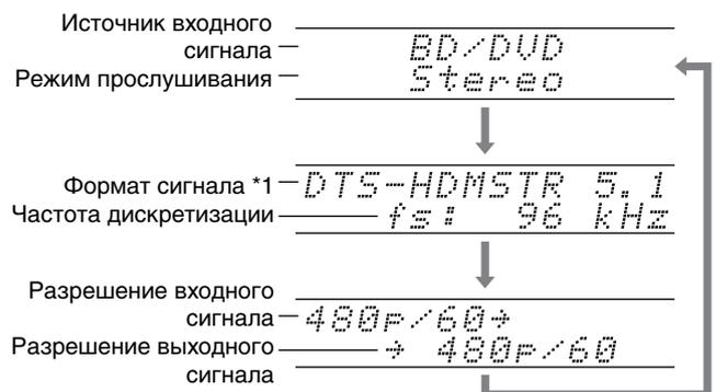
\*1 Если входной сигнал цифровой, отображается формат сигнала. Информация выводится в течение трех секунд, затем дисплей принимает прежний вид.
