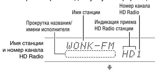
Если AV-ресивер имеет двухстрочный дисплей, канал HD, имя исполнителя и название композиции отображаются на второй строчке
