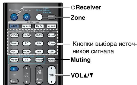
**1** Нажимайте последовательно кнопку **Zone**, затем направьте пульт дистанционного управления на AV-ресивер и нажмите кнопку **Receiver**. Зона 2/3/4 включится и на дисплее AV-ресивера загорается индикатор **Z2**, **Z3** или **Z4**.
